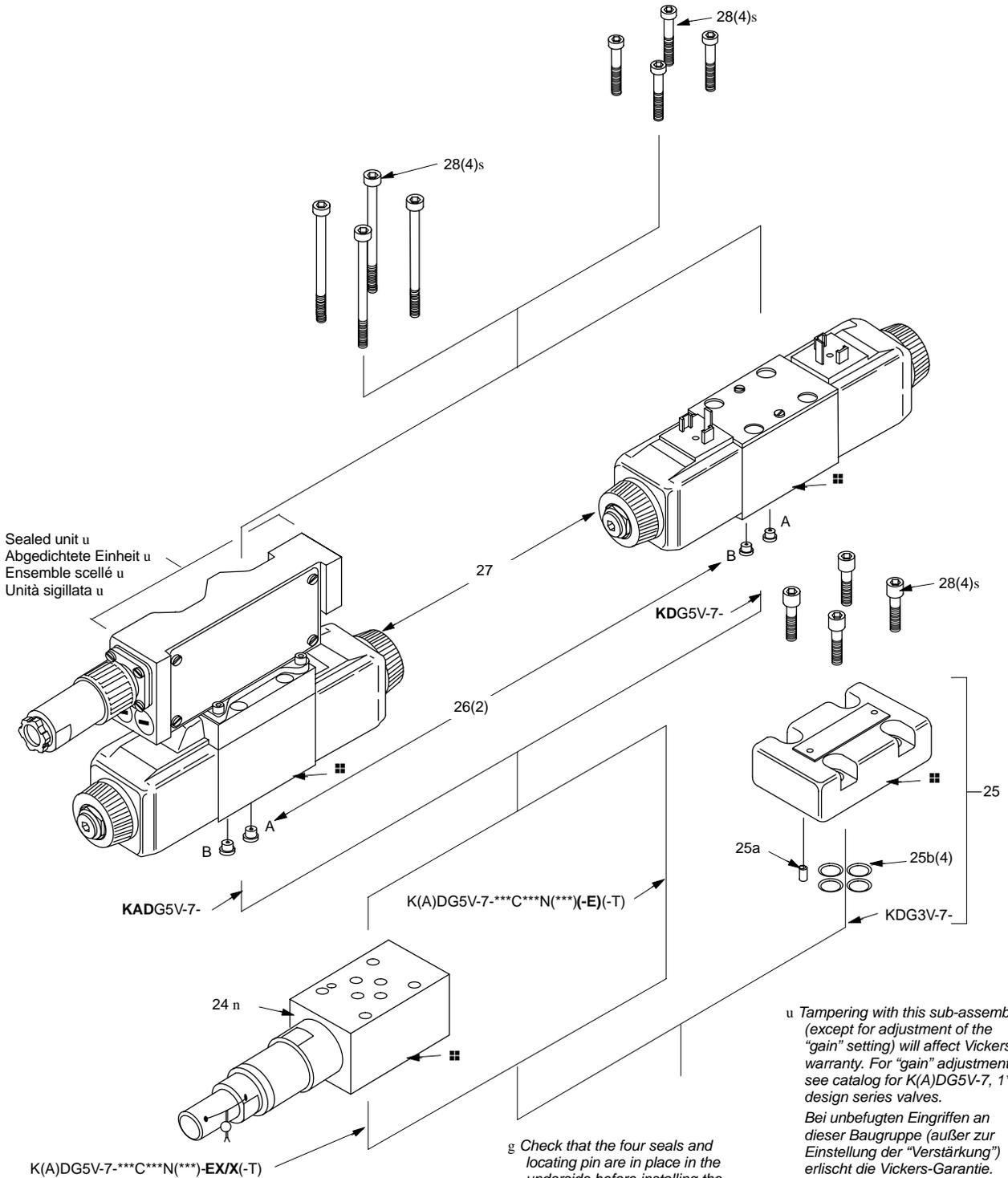
s 4 (0.157) A/F (7,4 - 9 Nm / 5,5 - 6,6 lbf ft lubricated / geschmiert / lubrificat / dopo lubrificazione).
